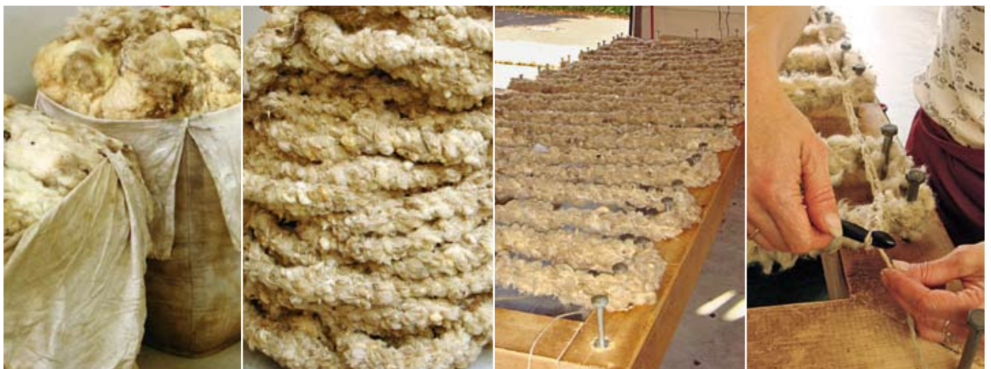
Die Rohwolle wird zu 4 cm dicken Wollsträngen verarbeitet, auf einen Holzrahmen mäanderförmig aufgespannt und von Hand verknüpft
